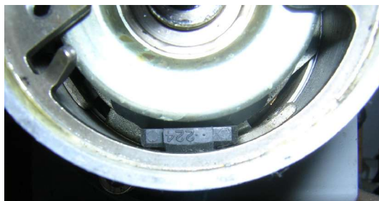
Foto: Blick unter die Verteilerkappe eines VW-Golf. Unten der schwarze Hall-Geber.
